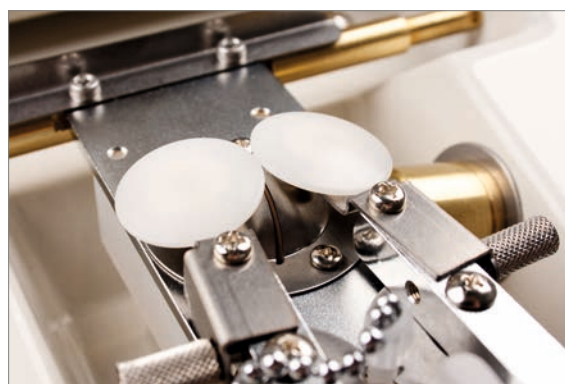
Obe vodili stekel imata plastična kolesčka, ki jih je mogoče zelo natančno nastaviti in s tem točno nastaviti položaj nad brusilno ploščo
