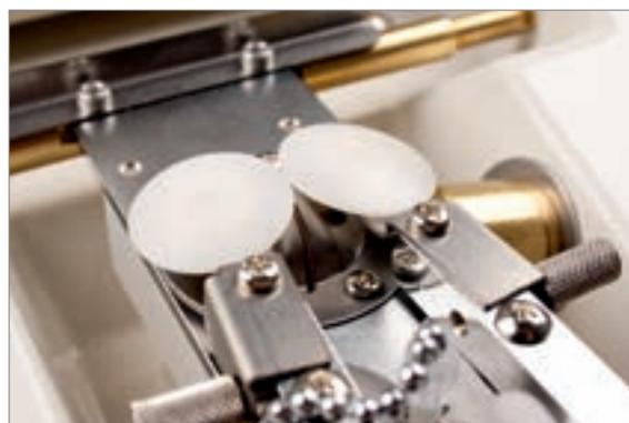
Obje vodilice za leće opremljene su plastičnim valjcima od kojih svaki može biti fino prilagođen kako bi se osigurao precizan položaj iznad brusne ploče
