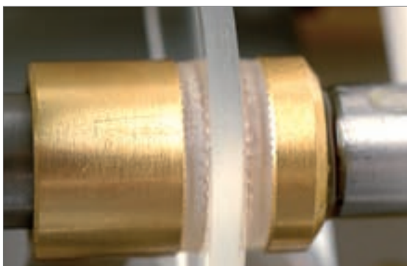
Mekani silikonski jastučići osiguravaju sigurno prijanje leća i ravnomjernu raspodjelu pritiska pri stezanju
