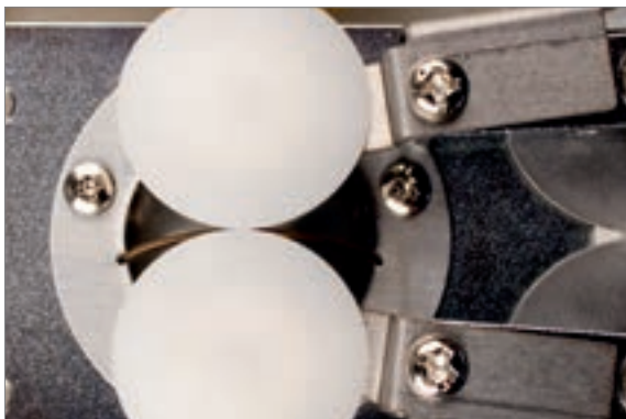
Velika, posebno montirana vodilica pogodnih za izradu utora u zahtjevnijim oblicima leća
